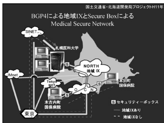
図3. BGP4 3) による地域IXとSecure BoxによるMedical Secure Network
