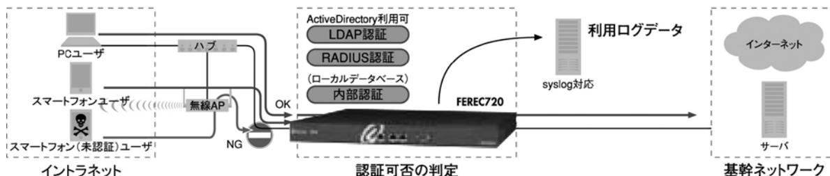
図 5 LAN アクセス管理ゲートウェイ「FEREC」
